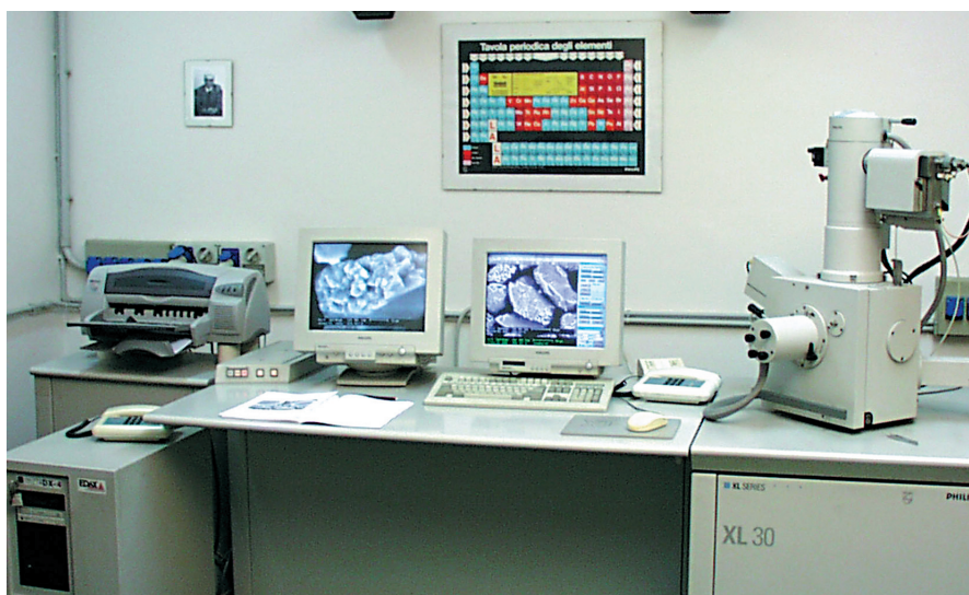
Stazione per la caratterizzazione morfologica e chimica di materiali di interesse in processi di trattamento termico disponibile presso l'IRC: Microscopio Elettronico a Scansione equipaggiato con sonda per la microanalisi
