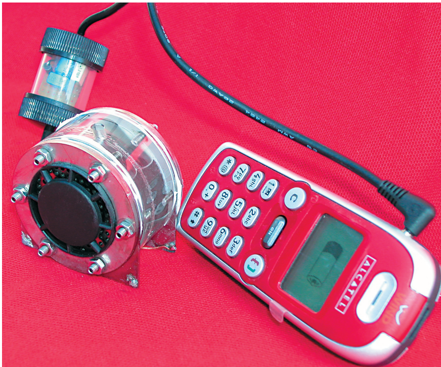
Alcune applicazioni della tecnologia HyPerMec su semplici celle monoplanari: luci di emergenza e carica-batteria di telefoni cellulari capaci di funzionare ininterrottamente per settimane con pochi millilitri di acqua-etanolo (10%)
