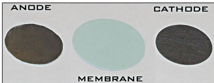
Gli elettrodi catalizzati e la membrana polimerica a scambio ionico sono gli elementi costitutivi della cella a combustibile e il «sito» della reazione elettrochimica
