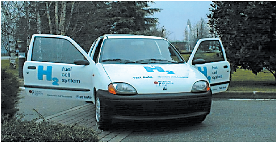
Figura 3. Seicento Elettra ad idrogeno realizzata dal gruppo Fiat in collaborazione con CNR ed Enea
