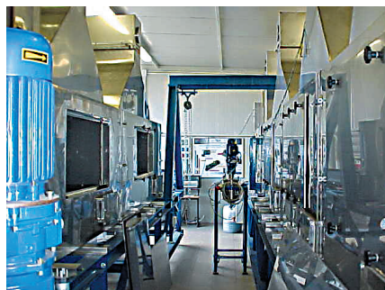
Figura 1. Impianto per la produzione automatica di elettrodi per celle a combustibile polimeriche
