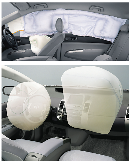
La struttura della vettura è stata calcolata privilegiando le doti di resistenza all'urto, anche laterale; gli airbag integrano doti di sicurezza già elevate
