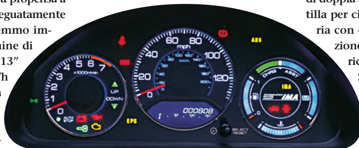
Il quadro strumenti è di impostazione classica; nello strumento a destra l'indicatore di carica delle batterie affianca quello della benzina; in alto, uno strumento a cristalli liquidi dà una misura delle condizioni istantanee di utilizzo o recupero dell'energia elettrica
