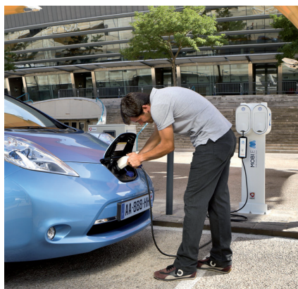
Nissan LEAF è un'elettrica alimentata da una batteria agli ioni di litio da 192 celle che eroga corrente a 345V e 90 kW di picco di potenza. Si ricarica dalla presa domestica o da una colonnina da 380V e offre un'autonomia di 160 km
