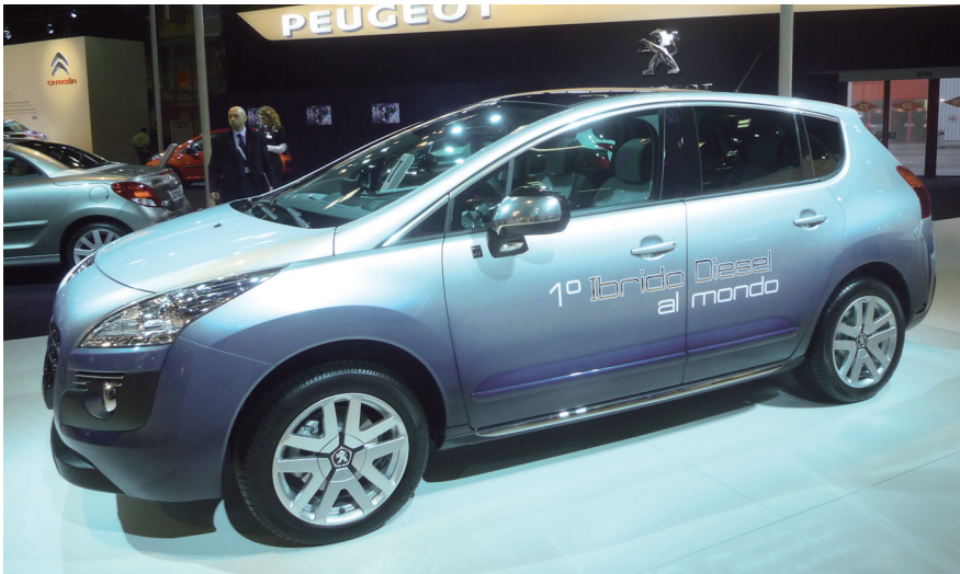
Crossover a quattro ruote motrici, Peugeot 3008 HYbrid4 è la prima vettura ad adottare un sistema ibrido basato su un motore a gasolio. Il 2 litri diesel da 163 cv accoppiato ad un propulsore elettrico da 37 cv emette 99 g/km di CO 2 e consuma 3,8 litri ogni 100 km
