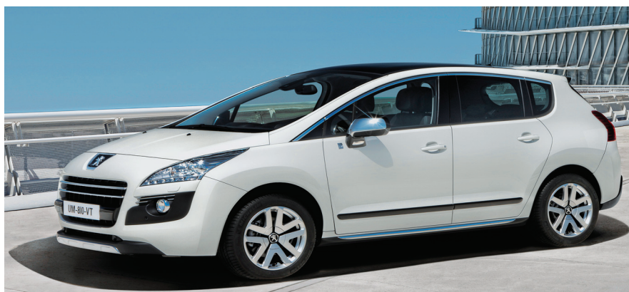
Il primo veicolo ibrido diesel al mondo si chiama Peugeot 3008 HYbrid4 e accoppia un 2 litri HDi FAP da 163 cv ad un elettrico da 37 cv. Grazie alla trazione integrale può muoversi su qualunque terreno e consuma 3,8 litri ogni 100 km, emettendo 99 g/km di CO 2
