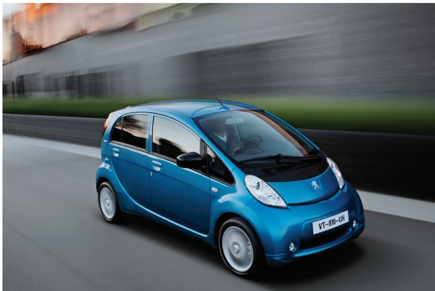
La iOn è la city-car del futuro «targata» Peugeot: 100% elettrica, zero emissioni e 150 km di autonomia per una velocità massima di 130 km/h. Lunga 348 cm, ha quattro comodi posti ed una dinamica di marcia brillante
