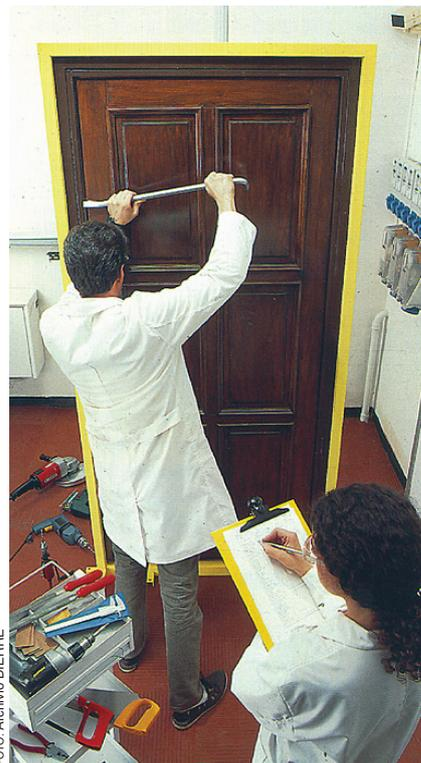
Secondo la normativa UNI 9569 la porta blindata deve superare numerosi test: prova di sfondamento lato cerniere e serratura; prova di forzatura e strappo della serratura; prova di sfondamento e perforazione del pannello anta. Le porte possono quindi rientrare in tre categorie antieffrazione; da classe 1 a classe 3
