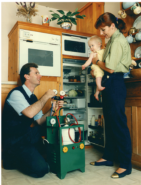
Intervento ecologico tramite dispositivo portatile per il recupero dei CFC dai vecchi frigoriferi e congelatori
