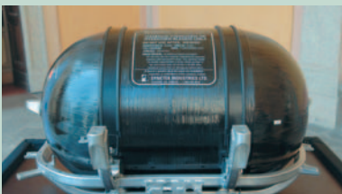
Da sinistra: il serbatoio idrogeno; il pacco di celle a combustibile ed il particolare del serbatoio idrogeno; il display collocato sul cruscotto con la visualizzazione dei flussi elettrici
