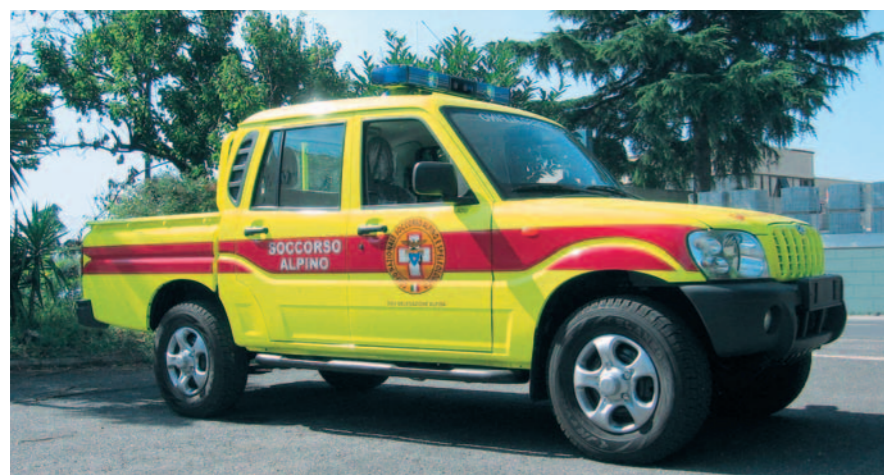
Cinque soccorritori, con relative attrezzature, possono raggiungere i siti più isolati grazie al riduttore, al differenziale autobloccante e alla buona disponibilità di coppia ai bassi regimi
