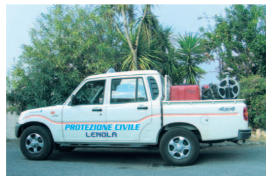
Con la configurazione a doppia cabina con modulo antincendio, il peso del serbatoio grava sulla verticale dell'assale posteriore, a vantaggio della stabilità di marcia
