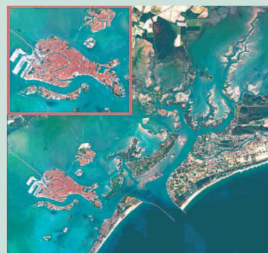
Ortofoto da immagine da satellite QuickBird, 16.5x16.5 km, della Laguna di Venezia (risoluzione multispettrale (RGB) a terra 2.4 m per pixel, e pancromatica 0.61m) e Mappa di concentrazione della clorofilla [Elab3DPoli e Telerilevamento, Polimi-DIAR, 2006]
